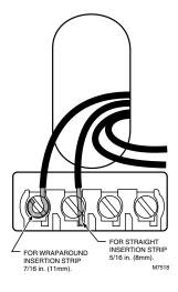
Fig. 3. Proper Wiring Technique.
